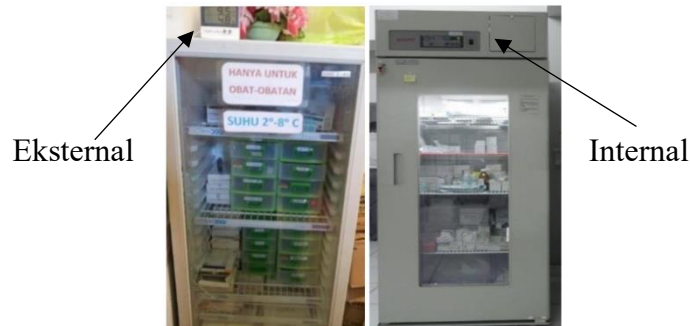
Gambar 2.11 Lemari pendingin dengan termometer eksternal (kiri) dan lemari pendingin dengan termometer internal (kanan)
