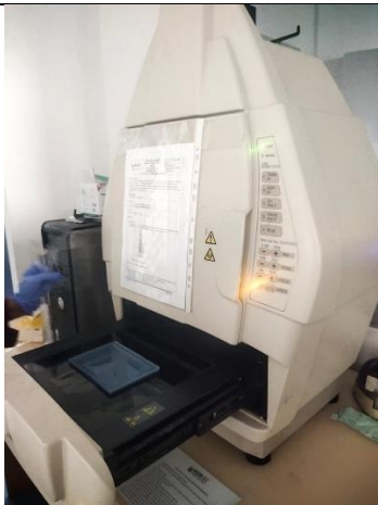
Proses pengamatan pita-pita DNA menggunakan alat Gel doc XR
