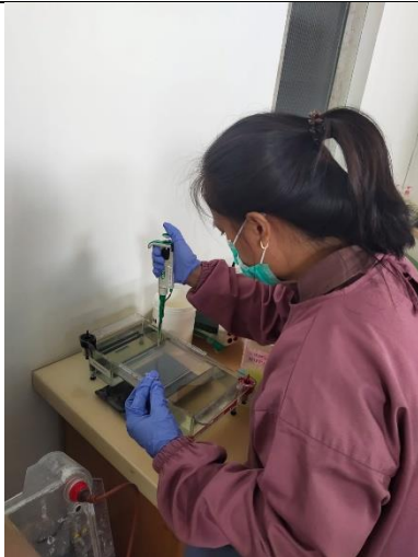
Penggunaan mikropipet dalam Elektroforesis Gel
