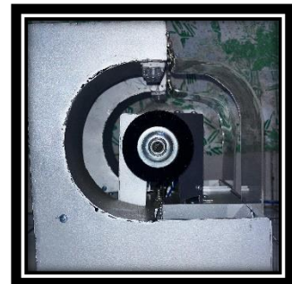
Gambar 4. 59 Pemasangan Brush (Sumber : Dokumentasi Pribadi)
