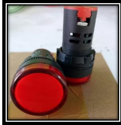
Gambar 4. 36 Lampu Indikator (Sumber : Dokumentasi Pribadi)
