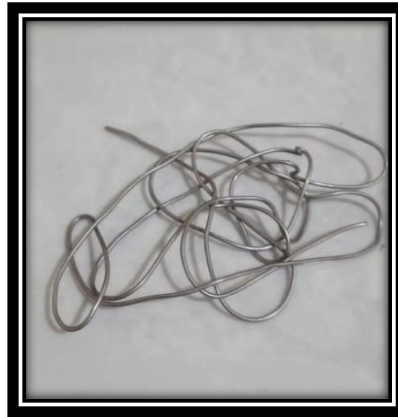
Gambar 4. 28 Timah Solder (Sumber : Dokumentasi Pribadi)
