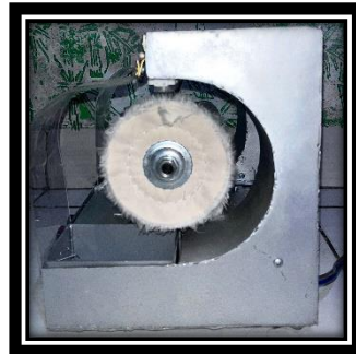
Gambar 4. 58 Pemasangan Kain Poles (Sumber : Dokumentasi Pribadi)
