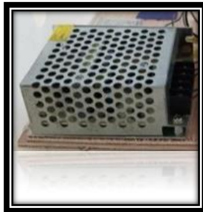
Gambar 4. 34 Power Supply (Sumber : Dokumentasi Pribadi)
