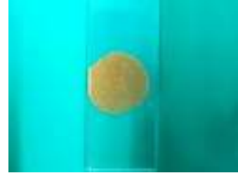
Gambar 27. Pengujian Homogenitas Setelah Cycling Test
